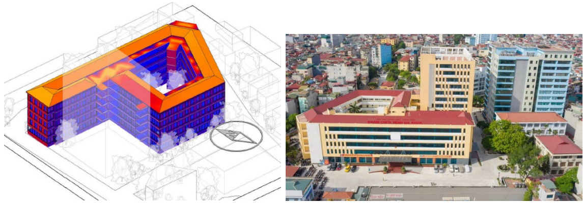
Hình 12 Ví dụ về hiệu quả che nắng hướng Tây trong tháng có mức BXMT cao nhất bởi tòa nhà kề bên ở Bệnh viện Y học PKKQ, Thanh Xuân, Hà Nội
